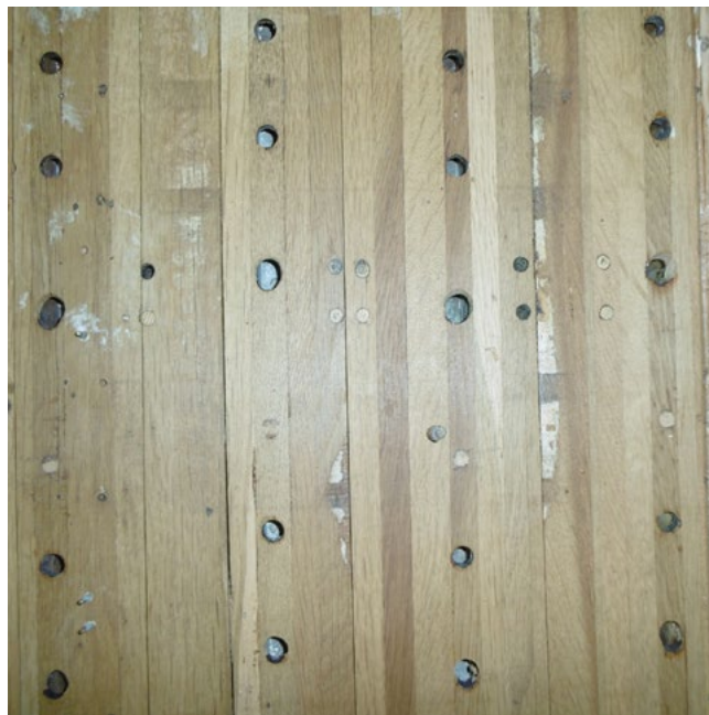
In der Bildmitte aufgeweitete Bohrungen sowie zusätzliche Bohrungen in der Koppelkanzelle, welche dort keinen Wind führt.
