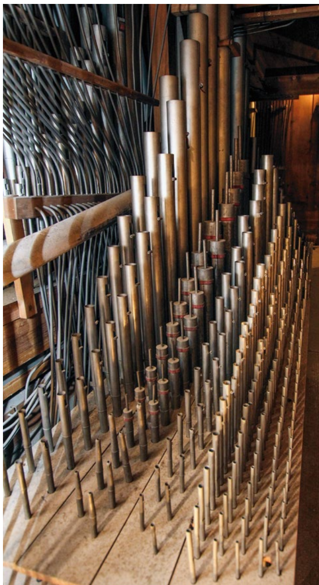
Pfeifenwerk auf der Unterlade des I. Manuals.
