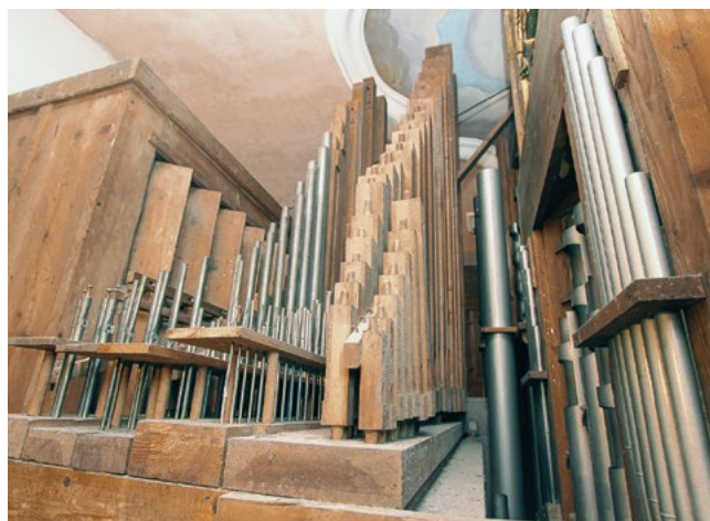
Pfeifenwerk auf der Oberlade des I. Manuals, dahinter der Schwellkasten des II. Manuals.
