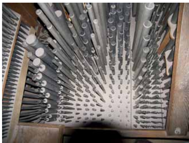
Ottobeuren, Dreifaltigkeitsorgel. Inneres mit den Registern Cornet (II+III), Flauta 8', Copel 16', Copel 8', Salicet 8', Praestant 4', Tertz 3', Flet 4', Gamba 8', Quint 3', Waldflet 2', Tertz 1 1 / 2 ', Princip 8'.
