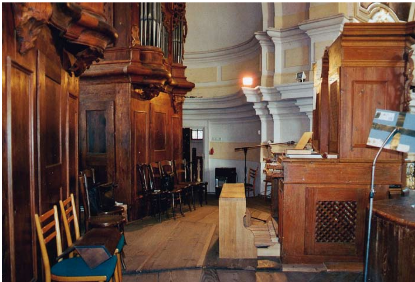
Weit verbreiteter Typ einer böhmischen Barock-Orgelanlage: Links geteiltes Hauptgehäuse, rechts Rückpositiv mit rückwärtig angebautem Spieltisch. Dobrá Voda (bei Budweis / České Budejovice), Frantisek Fialka aus Běchyně, 1760–61, II/12 (jetzt 13).
