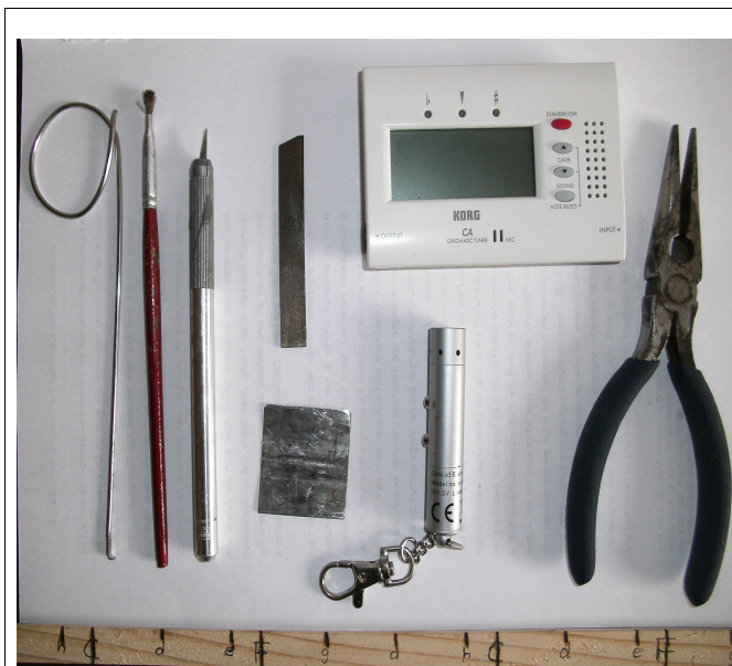
Abbildung 9: Werkzeuge zum Stimmen: Zungenzieher, feiner Pinsel, Skalpell als Kratzer, Feile, Metallplättchen, Stimmgerät, Taschenlampe, Spitzzange, „Zollstock“
