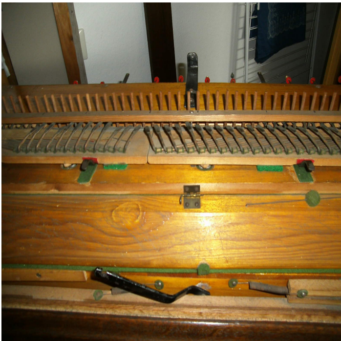
Abbildung 5: Oktavkoppeln, links Bass, rechts Diskant, dahinter die Steckerstäbe, vorne Forteklappe
