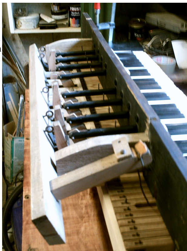
Abbildung 8: Registerkasten mit Mechanik "volles Werk" links
