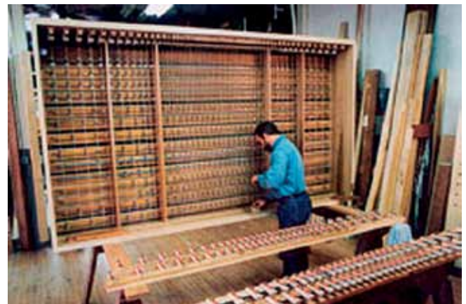
Trakturrahmen einer Universal Air Chest während der Montage.
