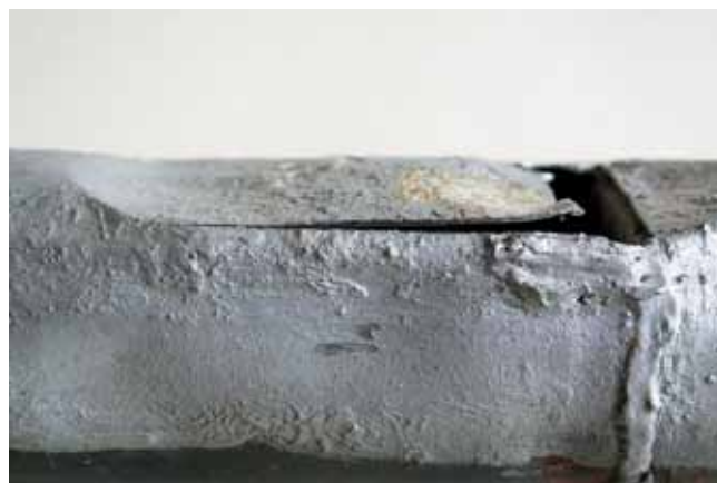
Seitenansicht des Labiumbereichs einer Prospektpfeife vor der Restaurierung.
