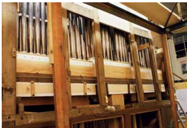
Windlade und Pfeifenwerk von hinten gesehen, nach der Restaurierung.
