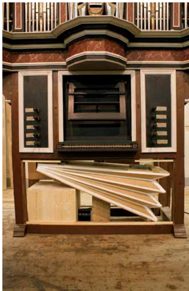
Die rekonstruierte Balganlage im Untergehäuse.
